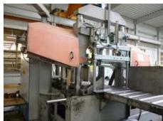
**709 BEHRINGER Bandsäge Ø 50 - 500 mm**
