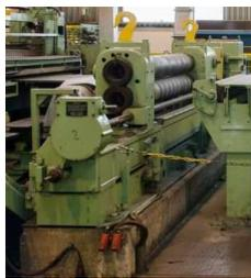
**520 COMEC ca. 80 Wechselscherengerüste (2 St.), v max. = 150 m/min 1.650 x Ø 165 mm**
