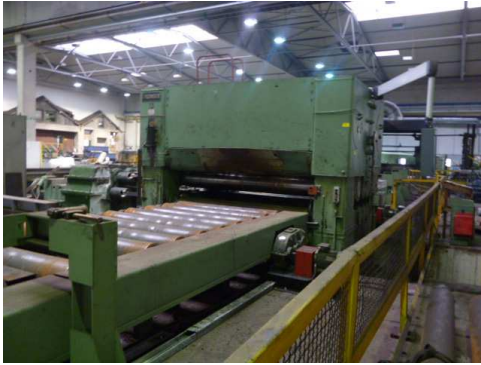
(0802) H. RAU WILDAU (SKET) Warmrichtmaschine 7 Richtwalzen Ø 345/290 mm 2.500 x 8 - 32 mm Baujahr 1978/2006
